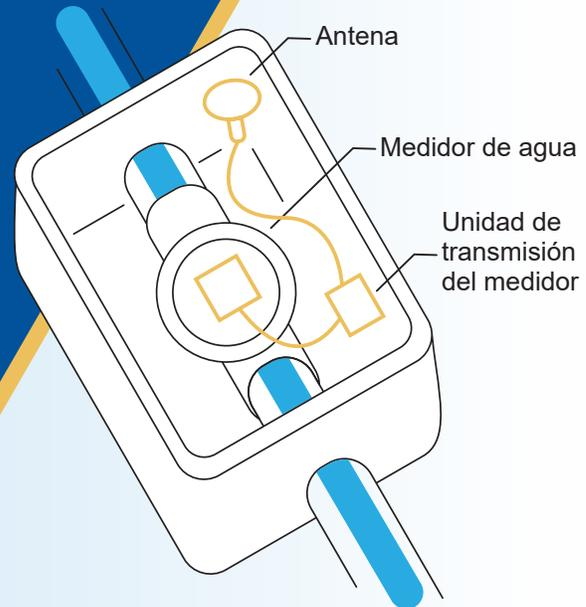
My ATX Water, el sistema de medidores de agua inteligentes de Austin, reemplazará los medidores de agua analógicos por medidores de lectura electrónica conectados a una red inalámbrica. Un portal del cliente proveerá datos diarios del uso de agua y notificaciones personalizadas. El proyecto es una estrategia importante para lograr los objetivos de conservación de agua del plan centenario de agua de Austin Water, conocido como Water Forward.
