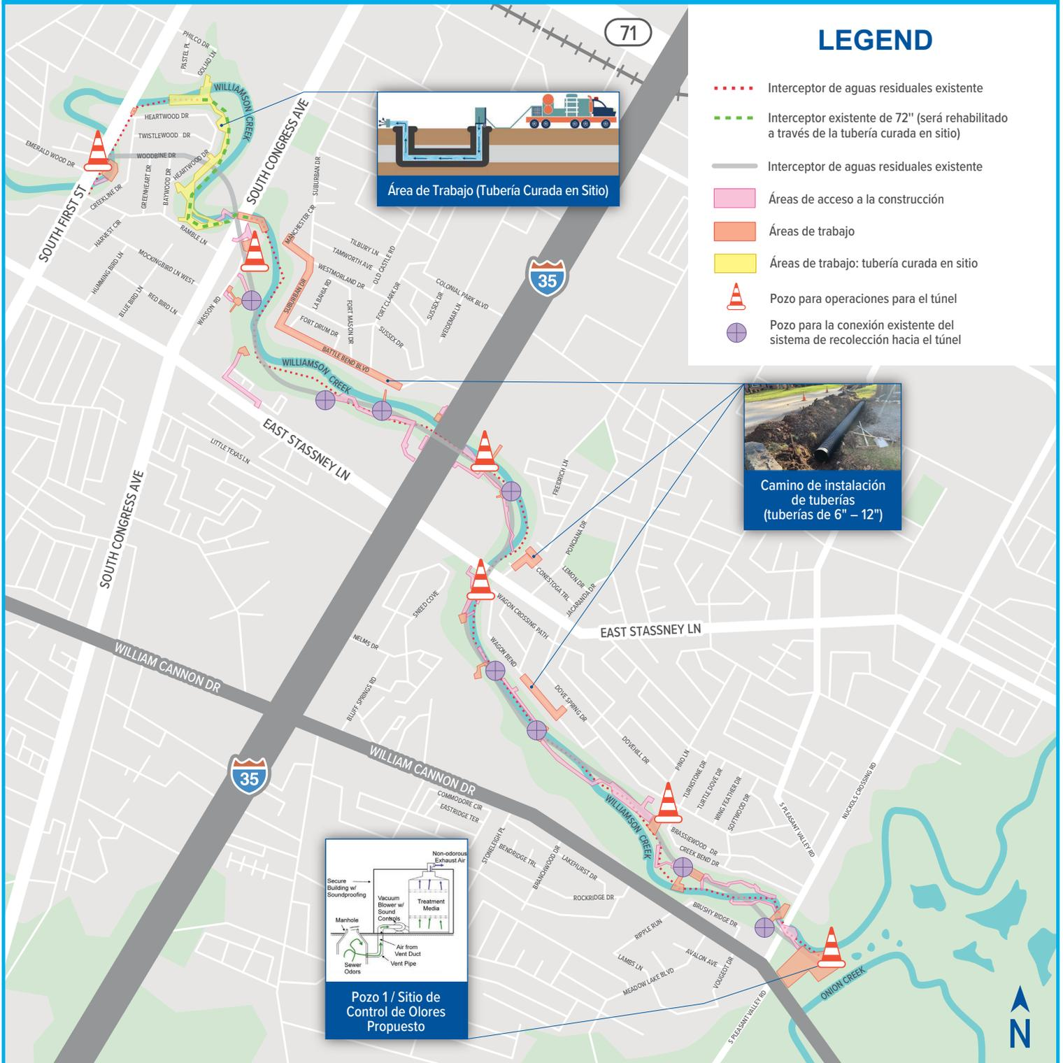
**Interceptor de Aguas Residuales:** Una tubería principal que recibe aguas residuales de líneas de recolección y las lleva a una planta de tratamiento. El interceptor de Williamson Creek lleva aguas residuales a la Planta de Tratamiento Residual Sur.
